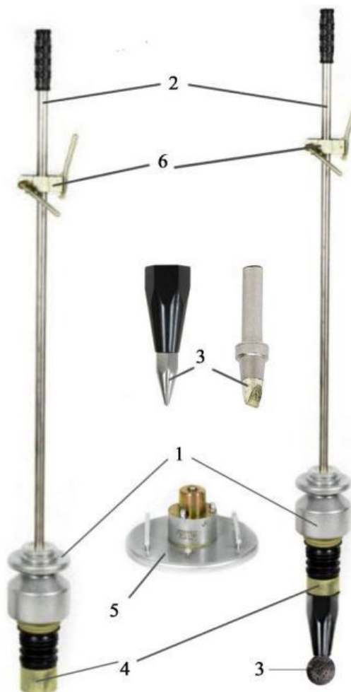
Рисунок 3.6 – Измеритель модуля упругости ПДУ-МГ4 трансформируемый за счет наконечника в устройство для разрушения льда
