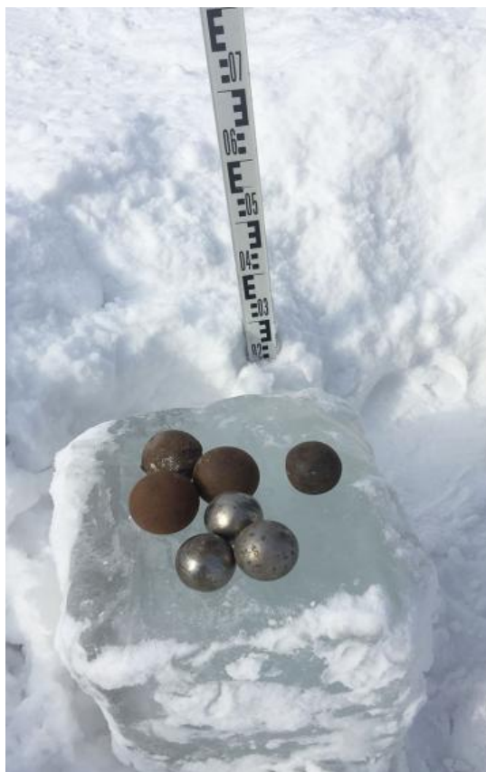
Рисунок 3.13 – Подготовка компонентов и оборудования экспериментов: ледяные кубы-образцы, металлические шары разной массы и мерная линейка
