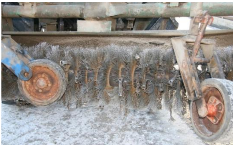
Рисунок 3.76 – Вариант опытно-промышленного образца льдоскалывателя, сочетающий в своей конструкции ударные звенья со щеточными
