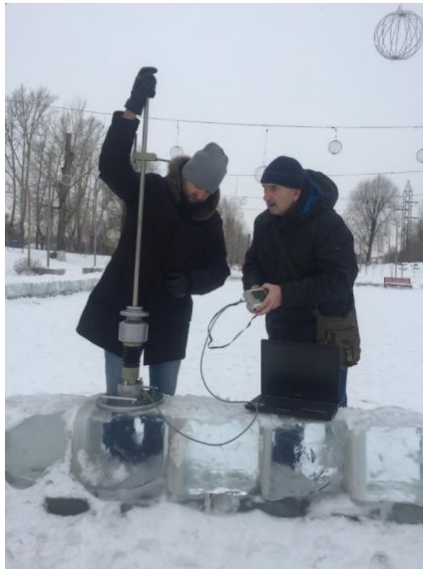
Рисунок 3.7 – Тарировка измерителя модуля упругости ПДУ-МГ4
