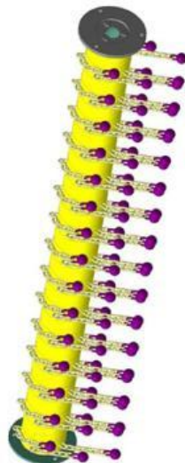
Рисунок В17 - Вариант комплектации рабочего органа льдоскальвателя съемными дисками со сферическими ударниками, чередующимися с пустыми звеньями – «с просветом»
