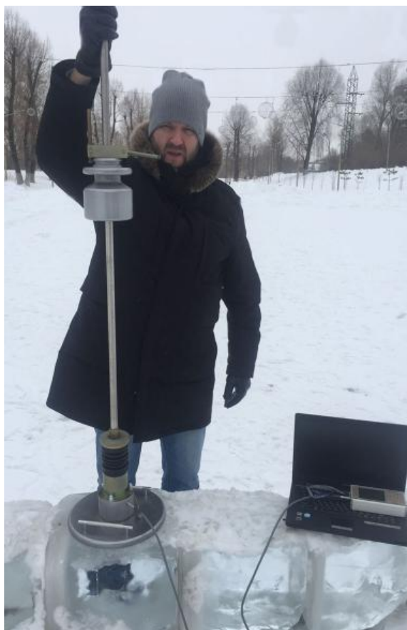
Рисунок 3.9 – Определение плотности льда при различной температуре
