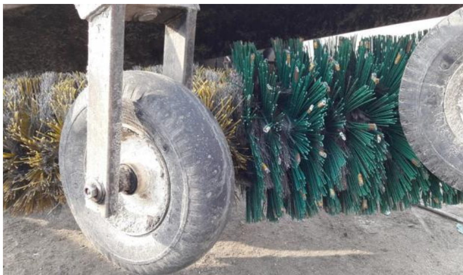
Рисунок 3.65 – Набор различных рабочих секций льдоскалывателя, смонтированных как комбинированный рабочий орган
