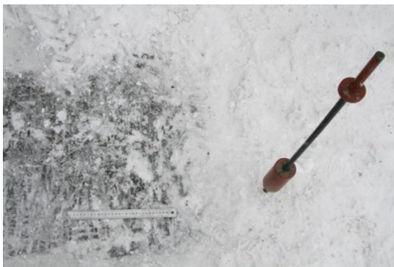
Рисунок 3.5 – Определение прочности льда ударником ДорНИИ
