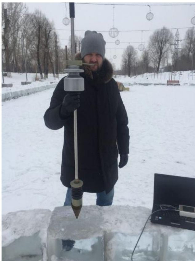
Рисунок 3.8 – Проведение лабораторных экспериментальных исследований, связанных с прочностными и геометрическими характеристиками льда на остовете плотномера с острым наконечником
