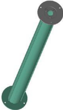
Рисунок В10 - Вал привода рабочего органа льдоскальвателя с опорным фланцем
