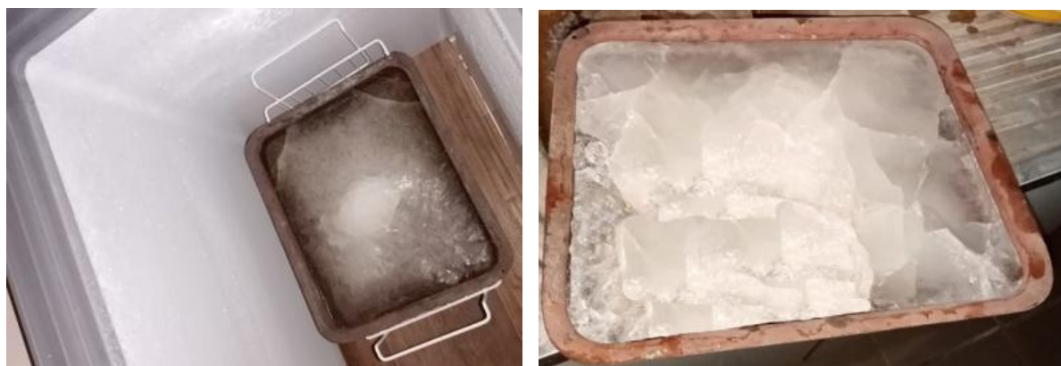
Рисунок 3.12 – Приготовление в холодильной камере образцов ледяного покрытия дорог для стенда определения сцепления льда
