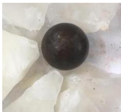
Рисунок 3.16 – Результат разрушения льда сферическим бойком диаметром 50 мм и массой 0,5 кг
