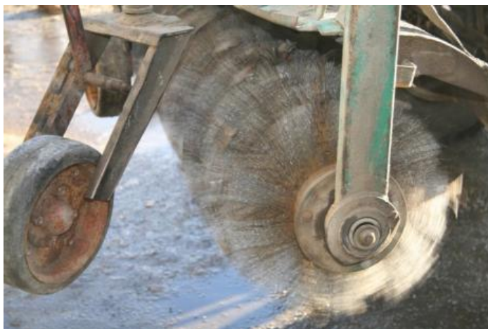
Рисунок 3.68 – Фрагмент работы инерционно-ударного рабочего оборудования по разрушению СЛЮ и ледяного покрытия дорог
