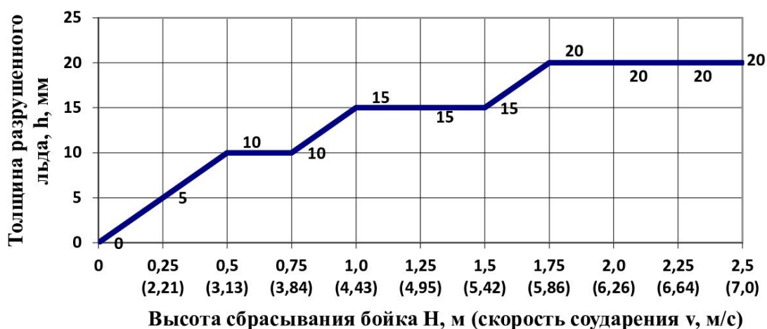
Рисунок 3.26 - Результаты экспериментов по разрушению льда бойком - стержнем
