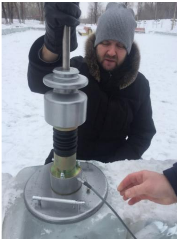
Рисунок 3.4 – Проверка модуля упругости образцов на плотномере ПДУ-МГ4
