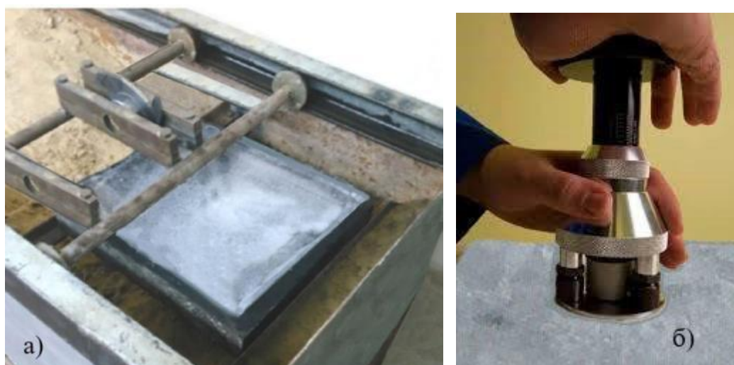
Рисунок 3.11 – Стенд (а) для определения сцепления льда с дорожным покрытием и определение адгезии (б) с помощью механического Адгезиметра
