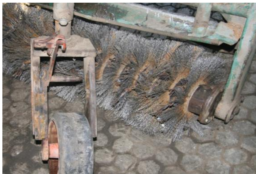
Рисунок 3.66 – Дробяще-сметающий набор рабочих секций навесного льдоскалывателя в сборе
