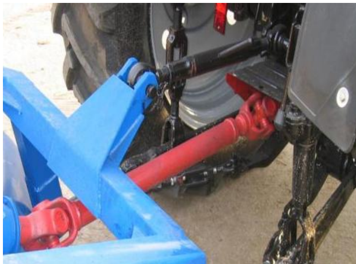
Рисунок 3.61 - Крепление и привод навесного оборудования на базовый трактор МТЗ-82
