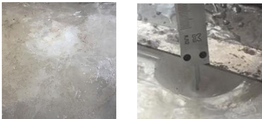
Рисунок 3.25 – Измерение глубины проникновения бойка в лед при его разрушении ударником ДОРНИИ со сферическим наконечником
