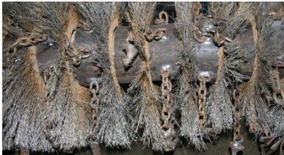
Рисунок 3.67 - Чередование рабочих секций с ударными сферическими элементами и сметающими сегментами
